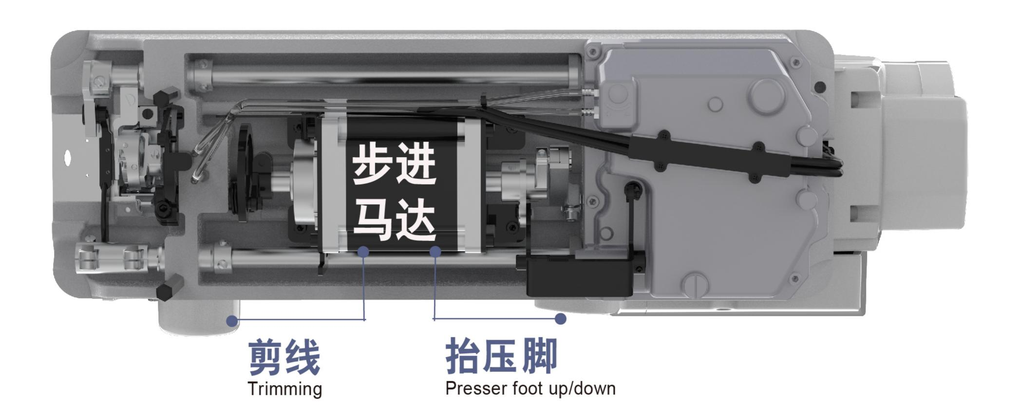
一个电机控制抬压脚与剪线(专利技术),方便压脚高度调整, 压脚升降无噪声,剪线平稳顺畅.
