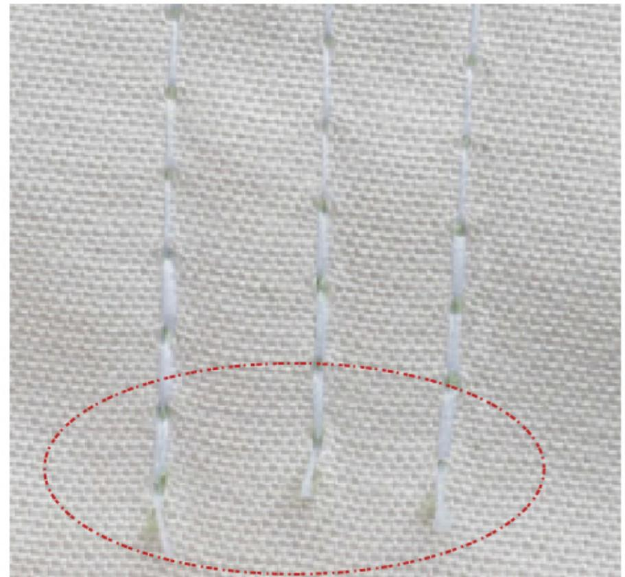
短线头：采用剪线凸轮驱动的双动力刀剪线结构,可在机针正下方完成剪线,缝纫后的线头最短可达3MM,可有效减少人工剪线的工作量。
