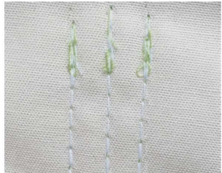
③ 短线头：采用电机驱动的双动刀剪线机构,可在机针正下方完成剪线缝纫后的线头最短可达3mm,可有效减少人工剪线的工作量。
