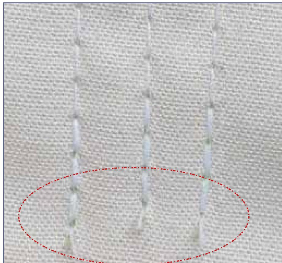
② 双动刀剪线结构，机针正下方完成剪线，线头最短可达3MM，有效减少人工剪线的工作量。
